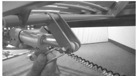
Der Motor ist jetzt vom Rückenteil getrennt und kann nach unten geschwenkt werden.
