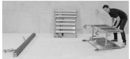
Die Endstücke mit den verbundenen Transporthalterungen auf ein Endstück kippen. Zum Oberflächenschutz eine Decke oder Karton unterlegen.
