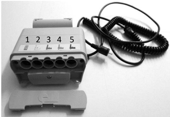
Das domiflex 2 / domiflex 2 wash ist mit einer Steuerung der Firma DewertOkin GmbH ausgestattet. An die Steuerung können vier Antriebe angeschlossen werden (Buchsen 2,3,4 und 5), die Buchse 1 dient zum Anschluss des Handschalters. Weitere Hinweise zur Farbcodierung können Sie dem Kapitel 4 „Aufbau und Bedienung“ entnehmen.
