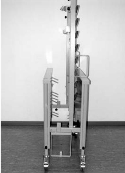
☞ Stecken Sie danach die andere Hälfte des Liegeflächenrahmens (Rückenlehne) auf die kurzen Aufnahmen, sodass das Kopfende (Aufrichterhülsen) nach unten zeigt. Die Matratzenbügel zeigen nach innen.
