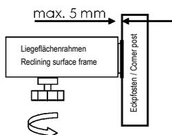
Zwischen dem Liegeflächenrahmen und den Eckpfosten des Betthaupts darf maximal 5 mm Abstand bestehen.
