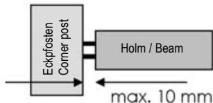
Stecken Sie dann das untere Paar der Metallzapfen in den 7 cm breiten Seitengitterholm.
