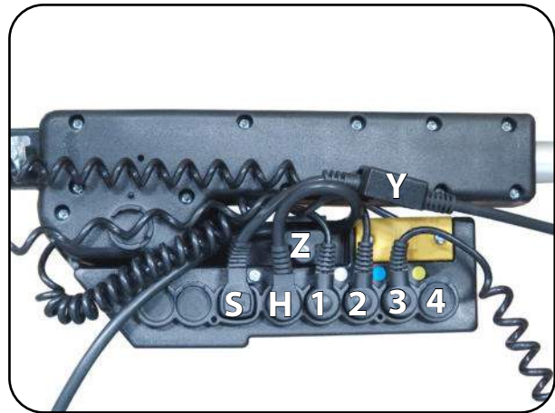
Abb. 6.2.05 - Steuerung mit Motorzuleitungen
