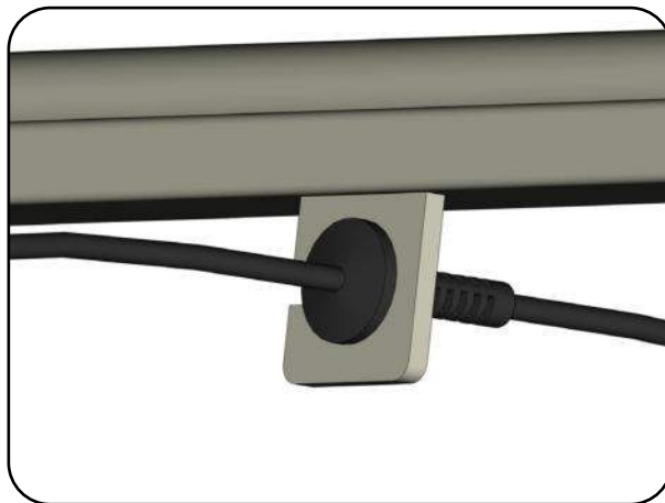
Abb. 6.2.03 - Zugentlastung in Halterung
