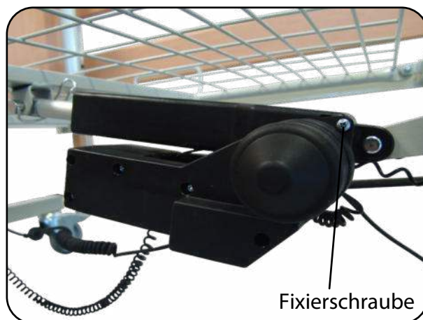
Abb. 6.2.02 - Steuerung an Rückenteilantrieb
