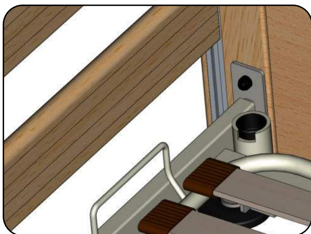
Abb. 9.01 – freie Aufrichterhalterung mit Transportsicherung
