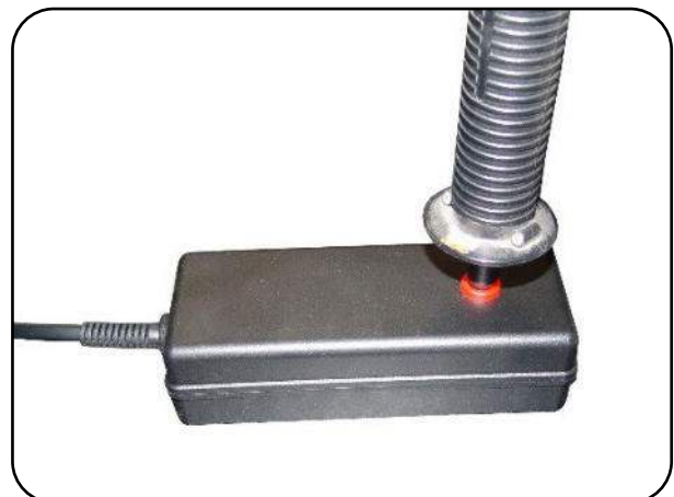
Abb. 19.02 – Adapter mit eingesteckter Prüfspitze
